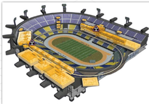
Meglévő vezeték nélküli hozzáférési pontok
