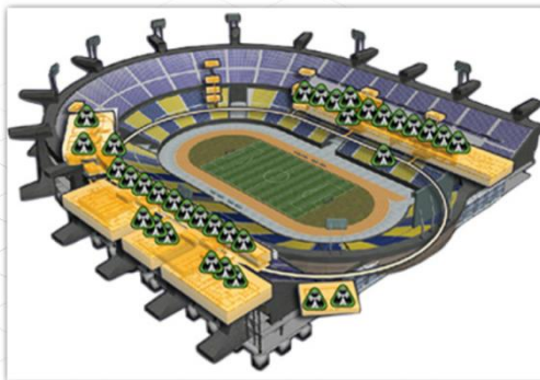
Meglévő vezeték nélküli hozzáférési pontok
